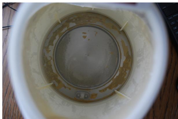
ワルシャワ市の一般家庭の湯沸かし器と湯沸かし器の底に残ったカルシウムのかたまり（黄土色の部分）。ワルシャワ市では、水道水の水はそのまま飲めず、家庭では必ず水道水を沸かしてから紅茶などにして飲むそうです。
